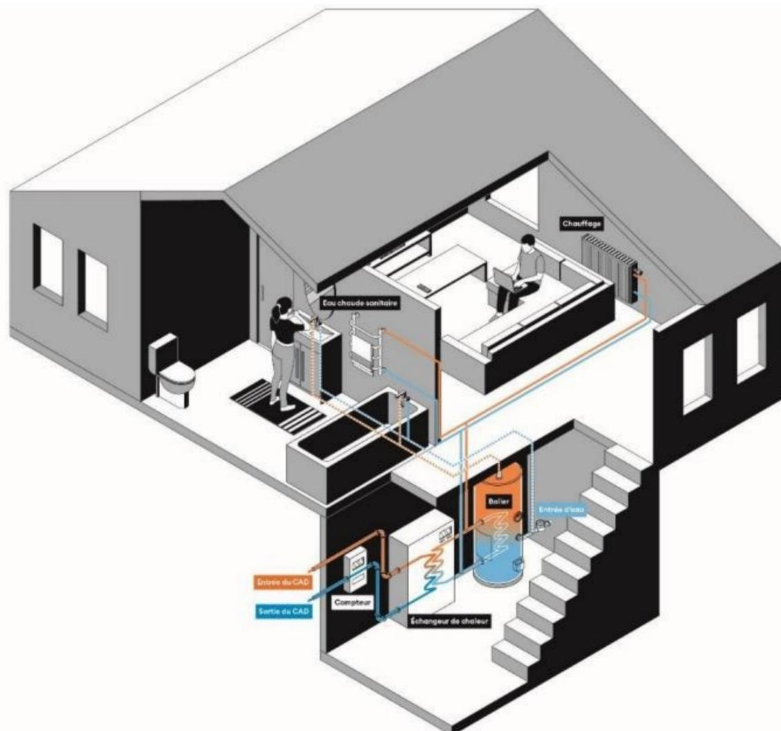
Figure 2 : Schéma de l'intérieur des bâtiments
